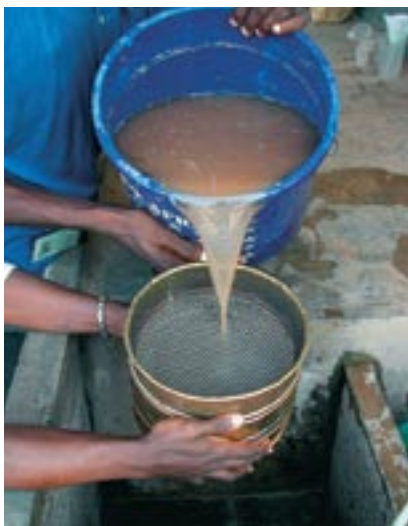
6. Verter la mitad del agua lentamente sobre tres tamices superpuesto de 2 mm, 250 y 150 \mu\text{m} .
