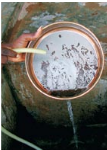
7. Lavar los residuos capturados sobre los tamices de 250 y 150 \mu\text{m} lavando los tamices por detrás si fuera necesario.
