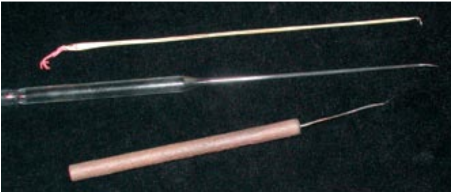
Figura 35. Una muestra de instrumentos para pescar nematodos: astilla de bambú; puntas de pipeta estiradas mediante calor, aguja de disección con una pestaña pegada a la punta.
