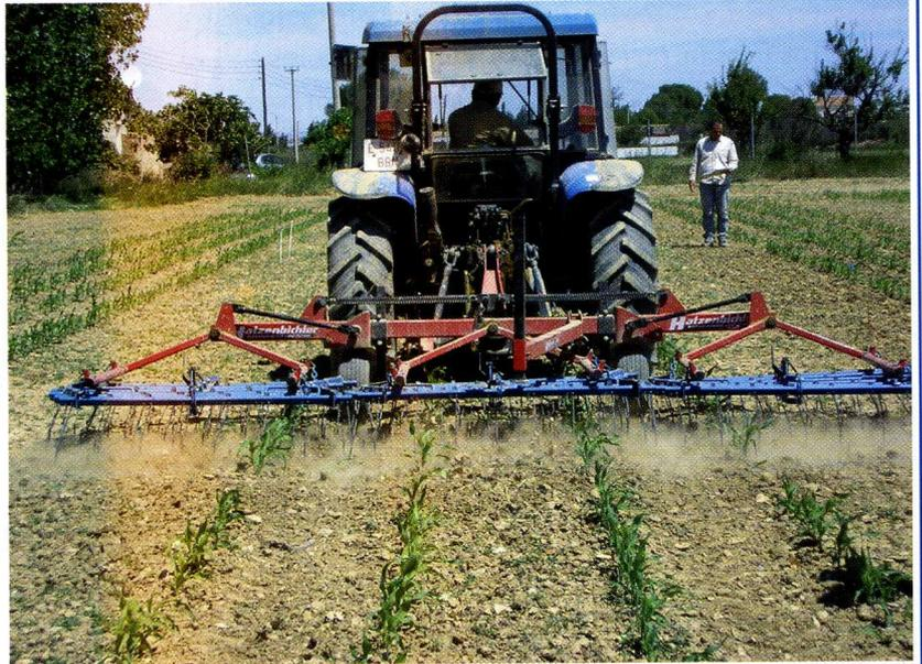
Foto 4. Detalle de la grada de varillas flexibles y el reglaje del ángulo de incidencia de las varillas para alcanzar menor o mayor profundidad y agresividad.
