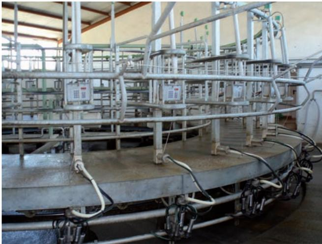
Figura 4. Unidad de ordeño compuesta por: cuatro conjuntos de pezoneras (pezonerera, casquillo, tubo corto de leche y tubo corto de pulsación), colector y tubos largos de leche y de vacío.
