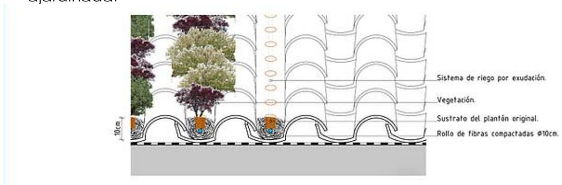
De la misma manera que las plantas del género Viscum colonizan los árboles, el sistema de cubierta vegetal viscum permite colonizar cualquier cubierta de teja curva convirtiéndola en una cubierta vegetal sin necesidad de retirar la teja existente.
