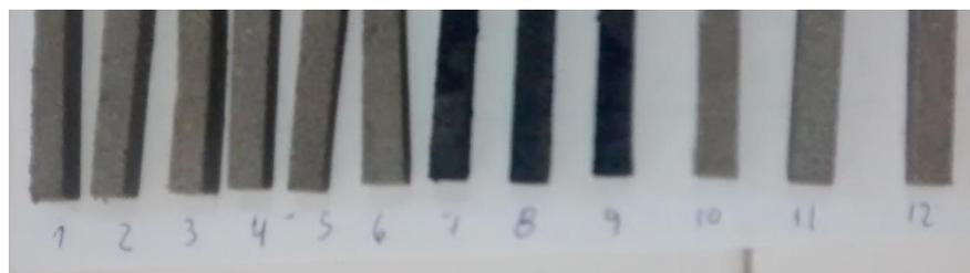
**Figura 6.20.** Probetas de cemento/arena/agua realizadas con los rellenos de las columnas post-filtración del TM. OMt150 (1-3), DMt150 (4-6), CA (7-9) y blanco (10-12).
