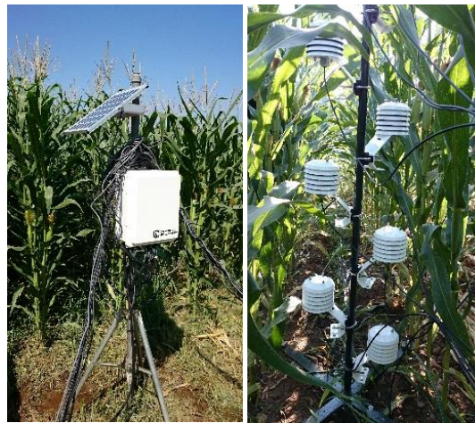
Figura 18. Sensores instalados en ensayos de maíz realizados en el Centro IFAPA Alameda del Obispo (Córdoba). Izquierda datalogger, Derecha sensores de temperatura y humedad.
