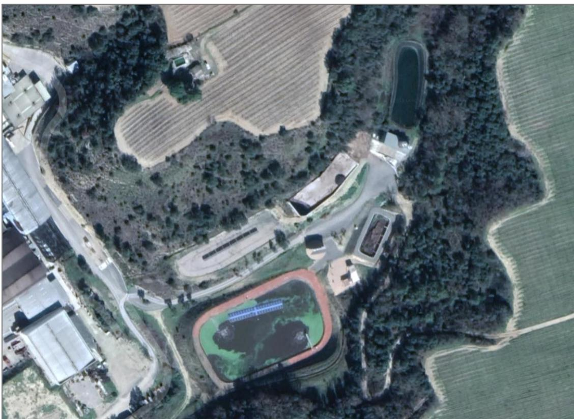
Figura 2. Vista aérea de la zona, después de la instalación de los prototipos. Se aprecian el conjunto de paneles solares flotante sobre la balsa, el conjunto fijo sobre el filtro de arena y el seguidor solar.
