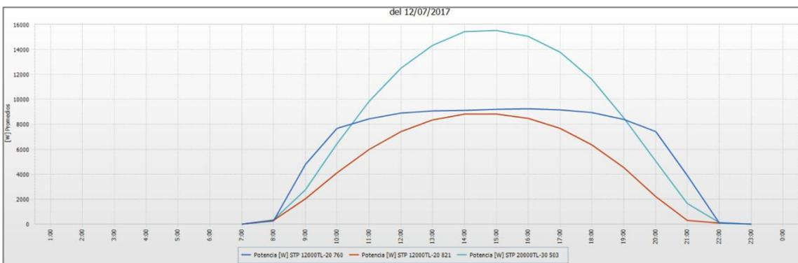
Figura 29. Gráficas de producción durante un día soleado (12/07/2017) de los tres campos fotovoltaicos: suelo (10 kWp), seguidor 10 (kWp) y flotante (20 kWp)
