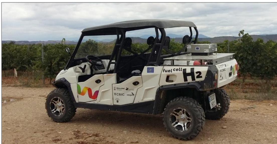
Figura 21. El vehículo operativo en campo, una vez incorporada la alimentación por hidrógeno y pila de combustible
