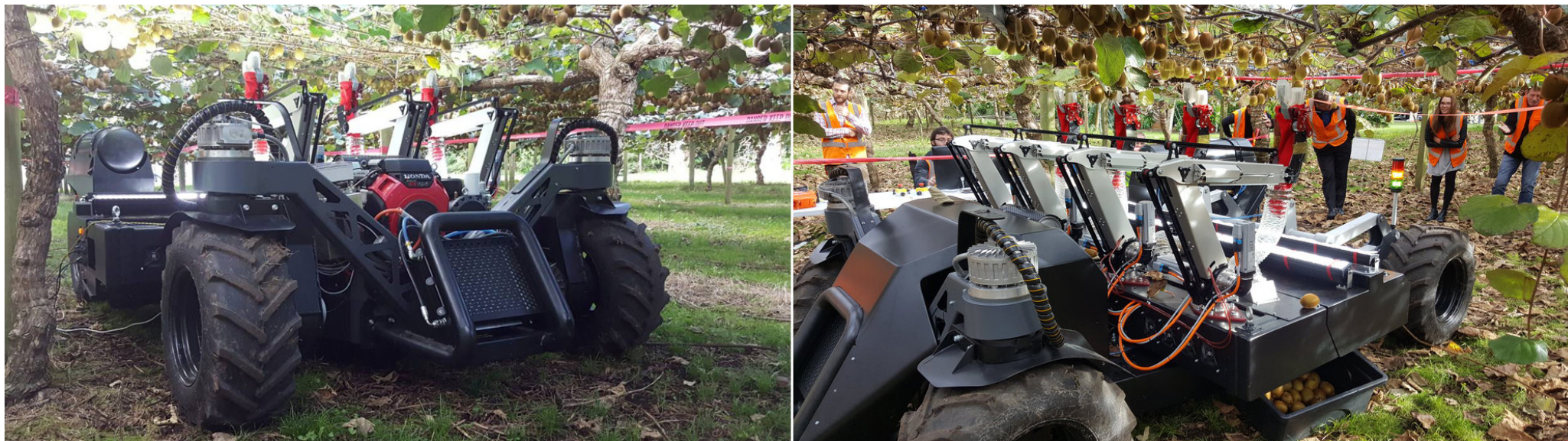
Prototipo de la empresa FF Robotics (Israel) para la recolección robotizada de la manzana por presión. A la derecha, detalle de los múltiples brazos y de las cintas transportadoras de la manzana, situadas a diferentes niveles.
