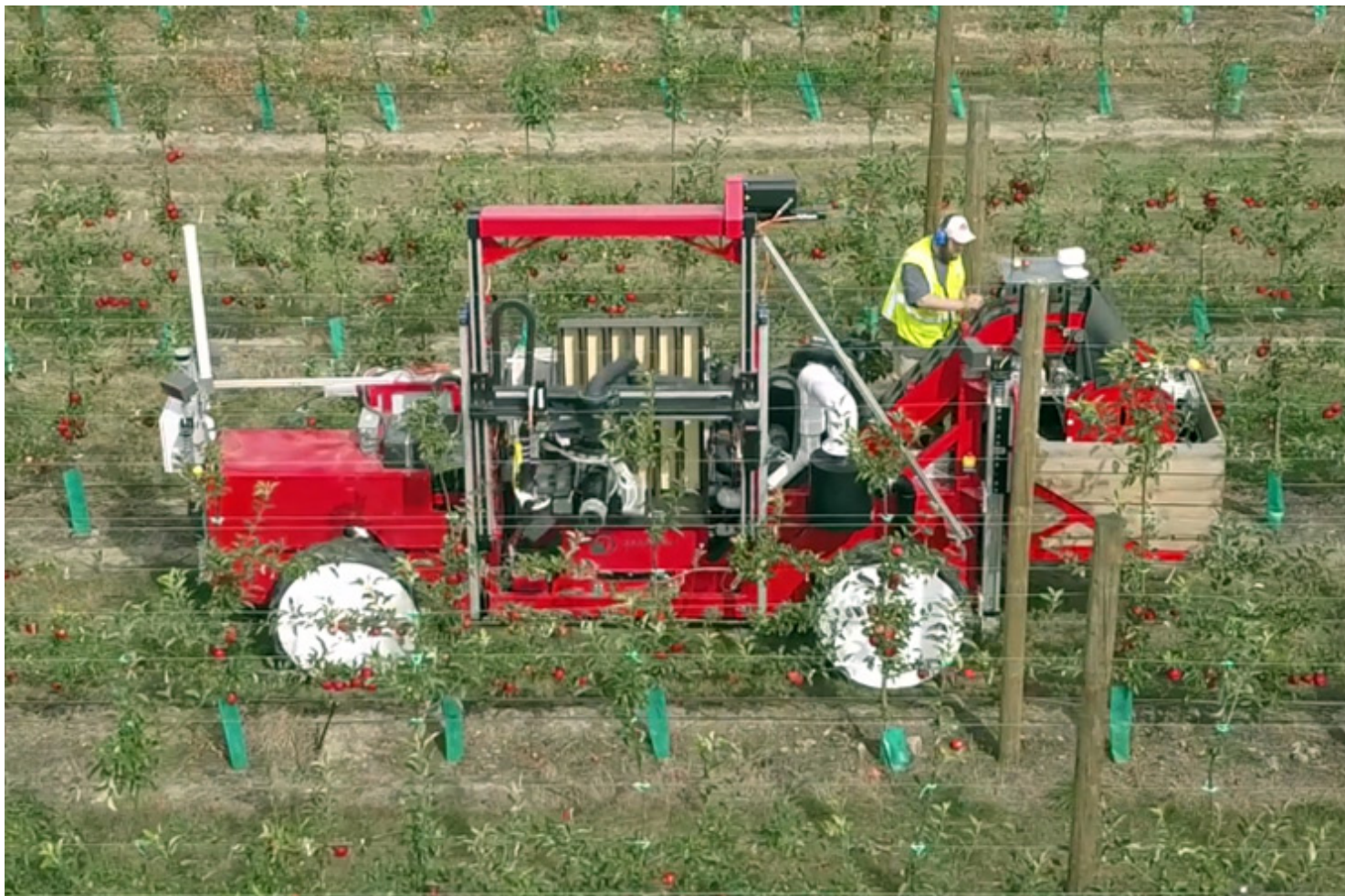
Prototipo para la recolección robotizada de la manzana por succión de la empresa Abundant Robotics (California-USA), trabajando en parcela comercial de Turners & Growers (Nueva Zelanda).
