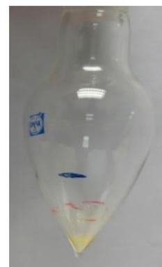
**Figura 18:** Matraz corazón con FFA evaporada hasta sequedad.
