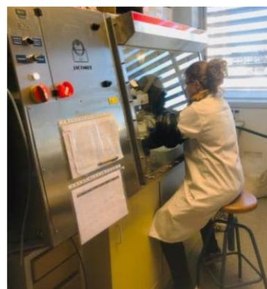
**Figura 14:** Embolsado de los viales de FFA del 2 y 10% etanol v/v en la cámara de anoxia.
