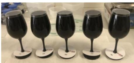
**Figura 16:** Copas con muestra de FFA tras hidrólisis química.
