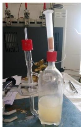
**Figura 20:** Sistema de extracción por borboteo.
