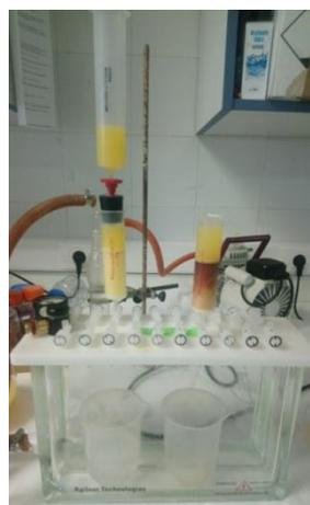
**Figura 13:** Percolación de la mistela desalcoholizada en cartuchos de C18 con ayuda del manifold.
