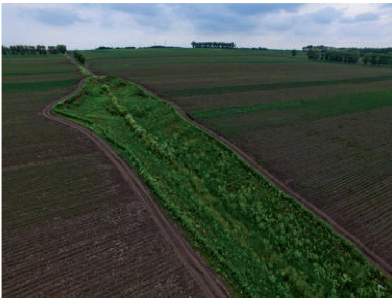
Figura 3.2.7.2. Medidas de vegetación para el control de cárcavas en la región de suelo negro del noreste de China (FotoL. Meng).
