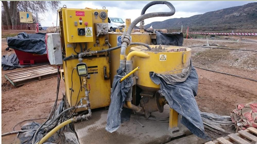
*Plataforma de inyección de lechada de cemento Atlas Copco Unigrout E15H110B.*
