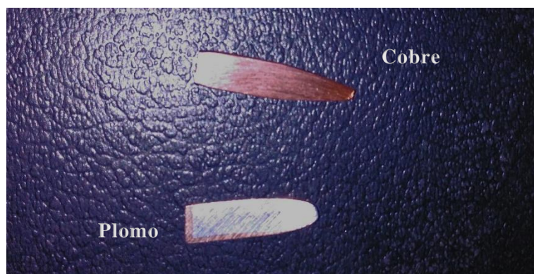
Imagen 2. Diferencia interna entre bala de cobre y plomo
