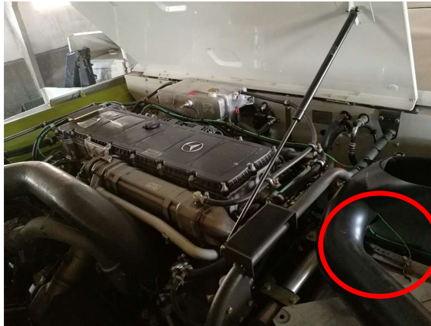
Termopar en zona de motor
