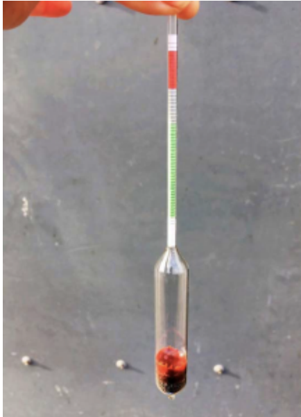
Figura 3. Se puede usar un calostrómetro de vidrio para medir la calidad del calostro.
