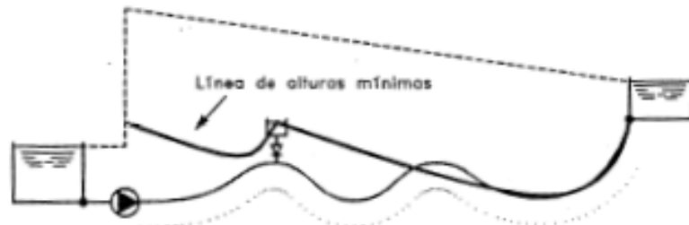
(a) Conducción con un tanque unidireccional
