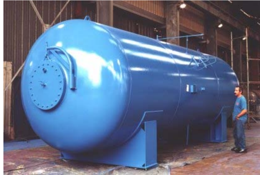
Calderín de 35 m 3 y 16 bar
